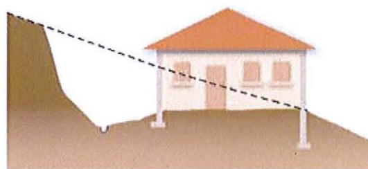
Plate-forme en déblais
